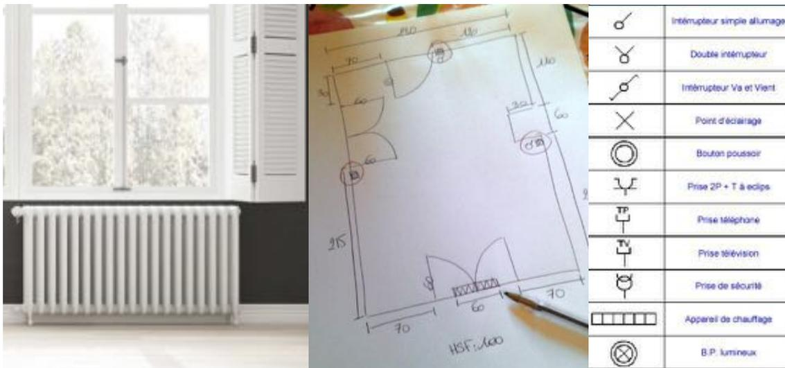
Placer les radiateurs ainsi que leurs dimensions (largeur, hauteur et profondeur)
