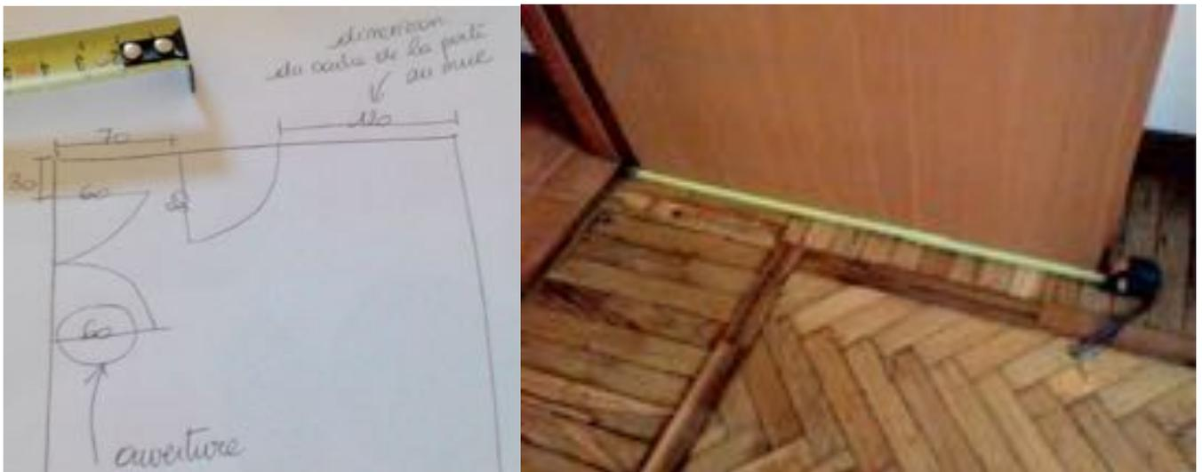
Dessiner les portes et fenêtres et noter l'encadrement total puis l'ouverture. Noter également les dimensions de chaque côté de l'encadrement.
