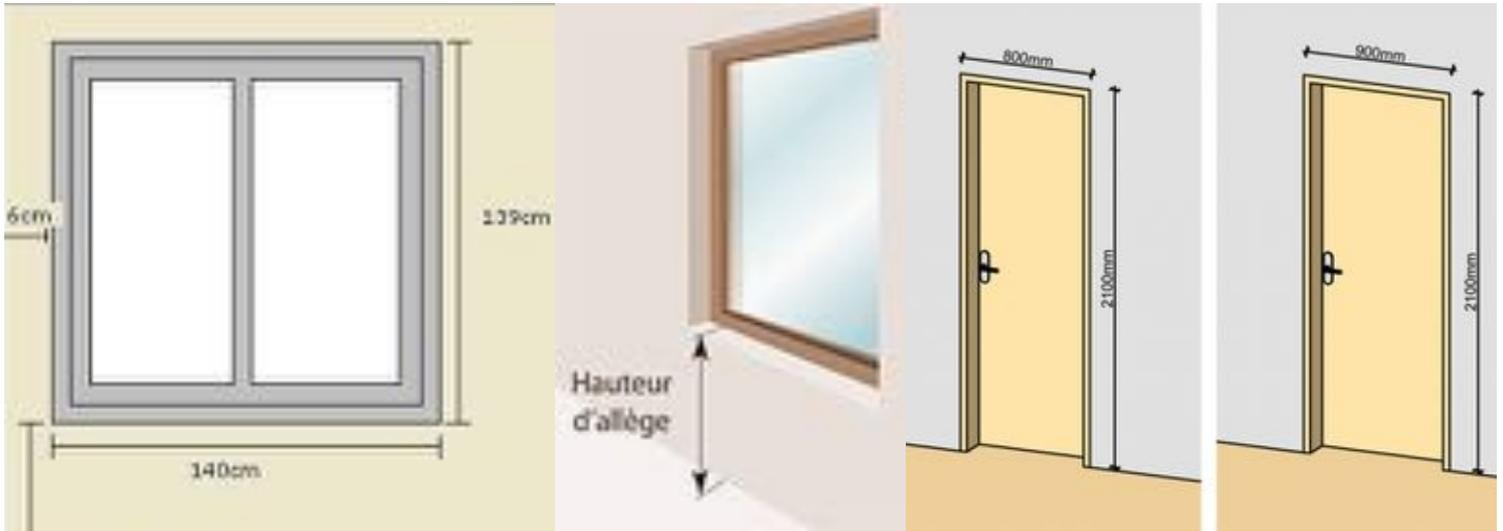
Noter la hauteur totale de l'ouverture (porte ou fenêtre), encadrement compris ainsi que l'allège restante sous la fenêtre (HSF)
